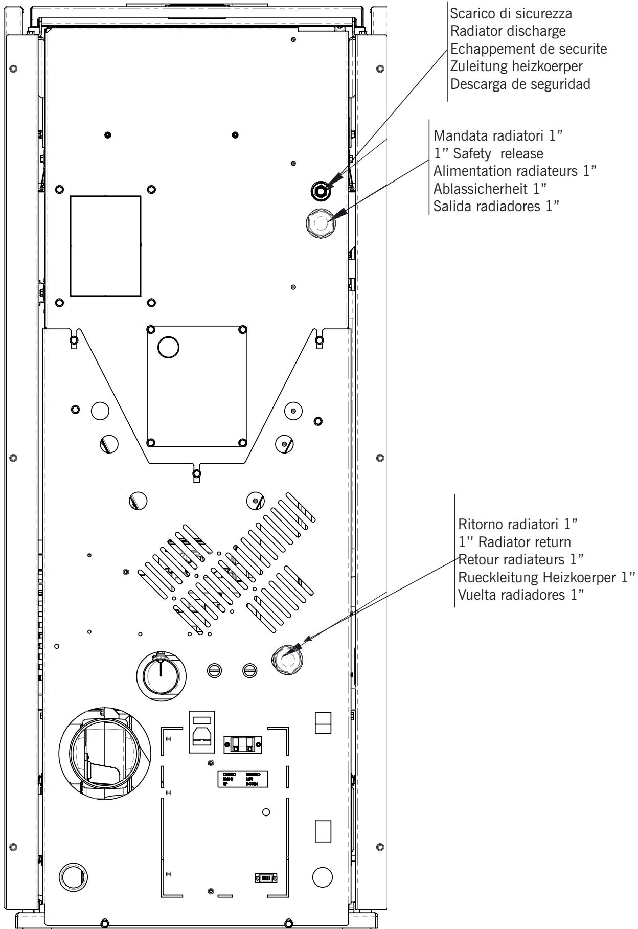
**Con kit sanitario / with sanitary kit / Avec kit eau sanitaire / / Con kit agua sanitaria**
